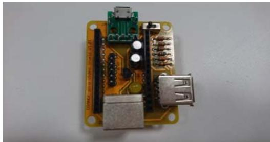
※写真ではC1、C2が電解コンデンサーになっていますが、最新版では積層セラミックコンデンサーに変更されました。
